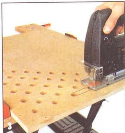
Ручки-отверстия вырезают электролобзиком по прямым линиям, соединяющим несколько вентиляционных отверстий. Наружные ребра всех вентиляционных отверстий притупляют.
