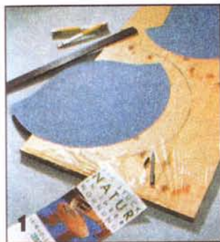
Контуров деталей размечают на заготовках с помощью картонных шаблонов. Следует избегать попадания линии резания на сучки.
